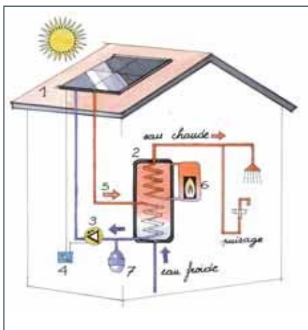
Fonctionnement d'un chauffe-eau solaire
